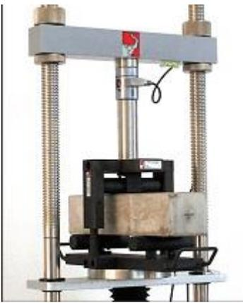
Испытание бетонных балочек на изгиб
